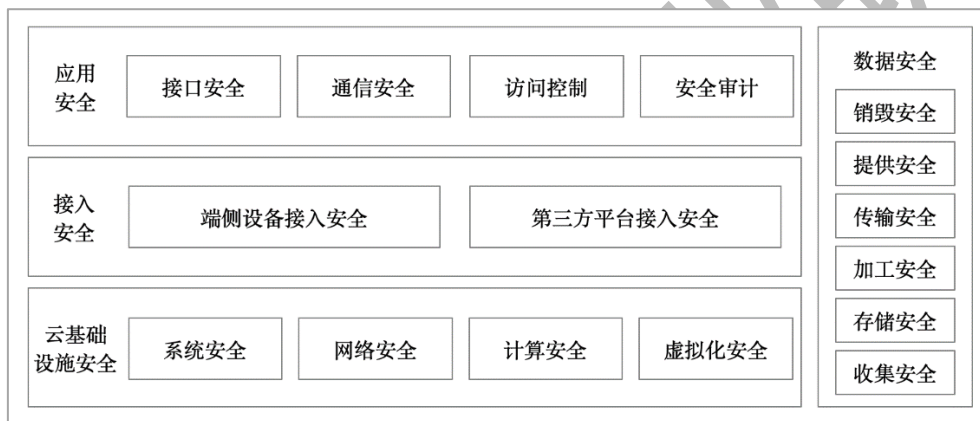
图 2 车路协同云控基础平台安全框架
