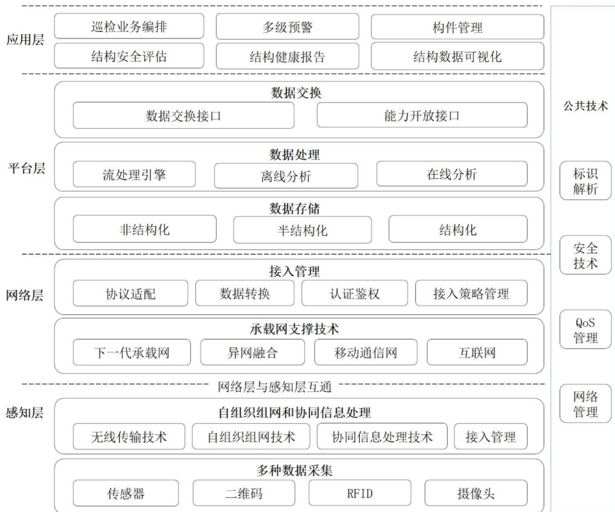
图1 基于BIM的桥梁养护管理信息系统总体架构
