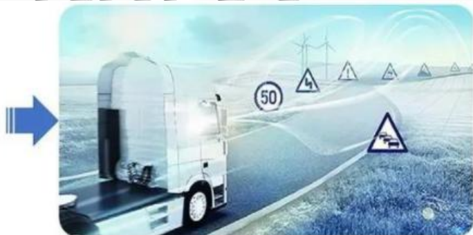
电子地平线使车辆能够预知前方道路坡度等路况信息
