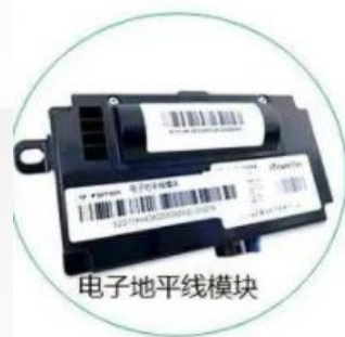
电子地平线使车辆能够预知前方道路坡度等路况信息
