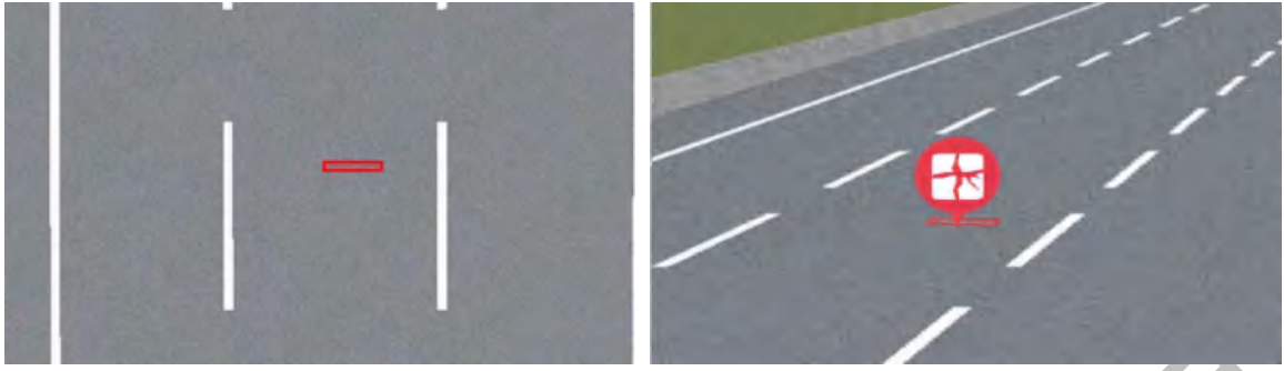
图 36 接缝料损坏几何表达图
