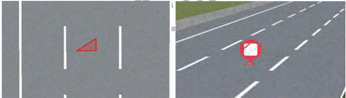
图 30 板角断裂几何表达图
